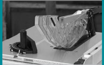
La mesa maquinada a precisión permanece plana y firme para una exactitud desde el primer corte
