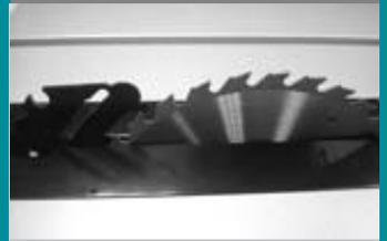
La cuchilla/separador se ajusta a 3 diferentes posiciones para cortes de traspaso, superficiales y ranurados
